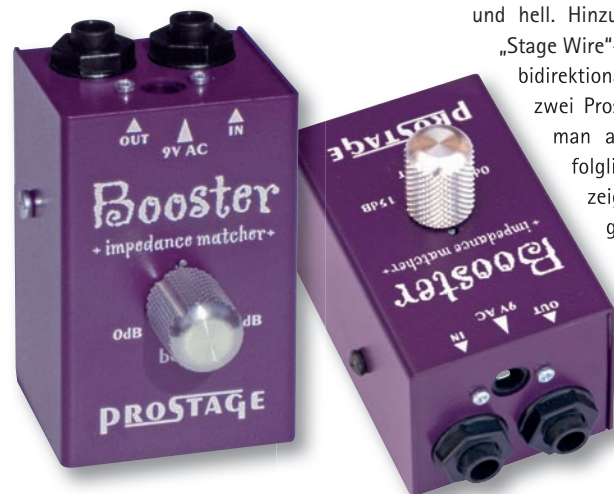
Kleines Helferlein: Mit dem XB1 Booster kann man sein Gitarrensinal optimal für die folgenden Geräte der Signalkette aufbereiten.
